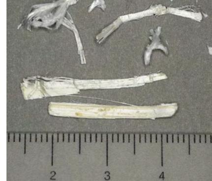
Esempio di analogie tra amianti e minerali fibrosi non regolamentati: necessità di indagini approfondite
